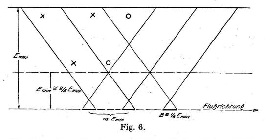
Die Disposition für den Folgebildanschluß mittelst Schrägaufnahmen ist schematisch in Fig. 6 angegeben. Bei einer Basis von ca.  $^{1}/_{8}$   $E_{max}$  beträgt die auswertbare Minimaldistanz  $E_{min}=^{2}/_{5}$   $E_{max}$ , und
