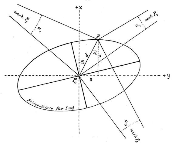
bzw. kleine Halbachse der Fehlerellipse dar. Um diesen Wert von  $\alpha$  zu erhalten, bilden wir den Differenzialquotienten  $\frac{\partial d}{\partial \alpha}$  und setzen ihn gleich Null.
