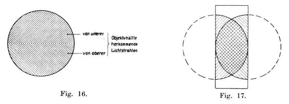
gleiche, d. h. für diese ist nur die untere Objektivhälfte nutzbar. Daraus folgt, daß wir für die obere und untere Hälfte des Gesichtsfeldes völlig getrennte Bilder haben, wobei sich dieselben auf der feinen Brechungskante ohne Zwischenräume oder Ueberdeckung berühren.
