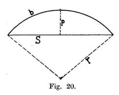
wärts gebogen ist, positiv oder negativ ist, was aus Figur 20 leicht hervorgeht. Anderseits wird die Ablesung zu groß, weil die Bilder um die Sehne S gegeneinander verschoben werden, diese Verschiebung aber an dem längeren Bogen b abgelesen wird. Der Unterschied zwischen Bogen b und der Sehne S kann bei der Pfeilhöhe p zu  $\frac{2p^2}{S}$  angenommen werden.
