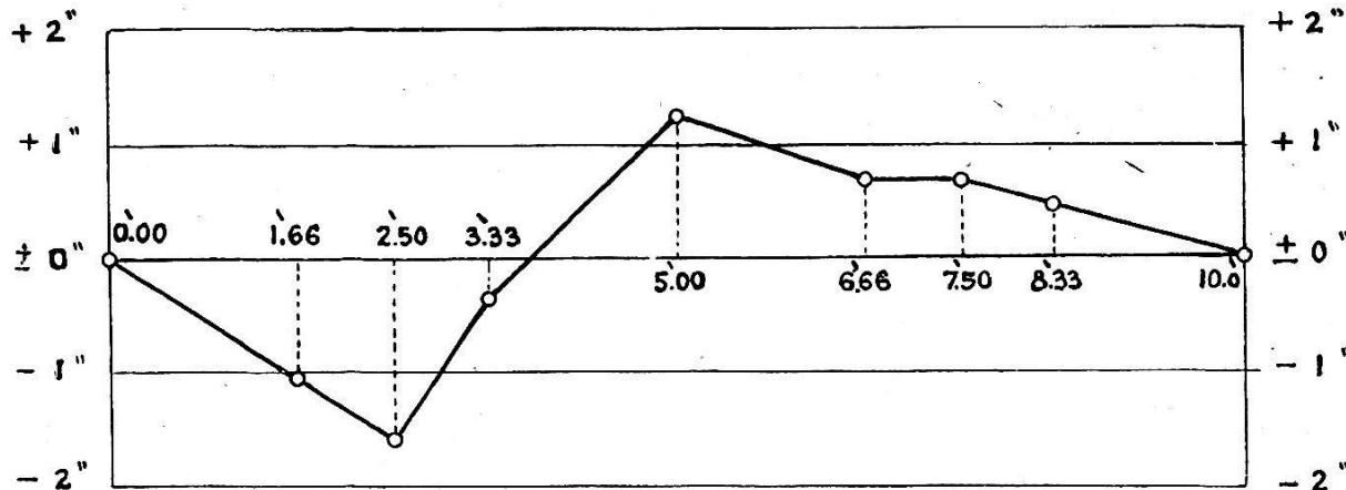
Aus obiger Fehlerreihe errechnet sich ein mittlerer Fehler des optischen Mikrometers von  $\pm 0.9''$ . Dieser Betrag kann bei den Richtungsmessungen der Triangulationen III. und IV. Ordnung, für welche der Theodolit bestimmt ist, vernachlässigt werden und nur bei feineren Messungen ist er unter Umständen in Betracht zu ziehen.
