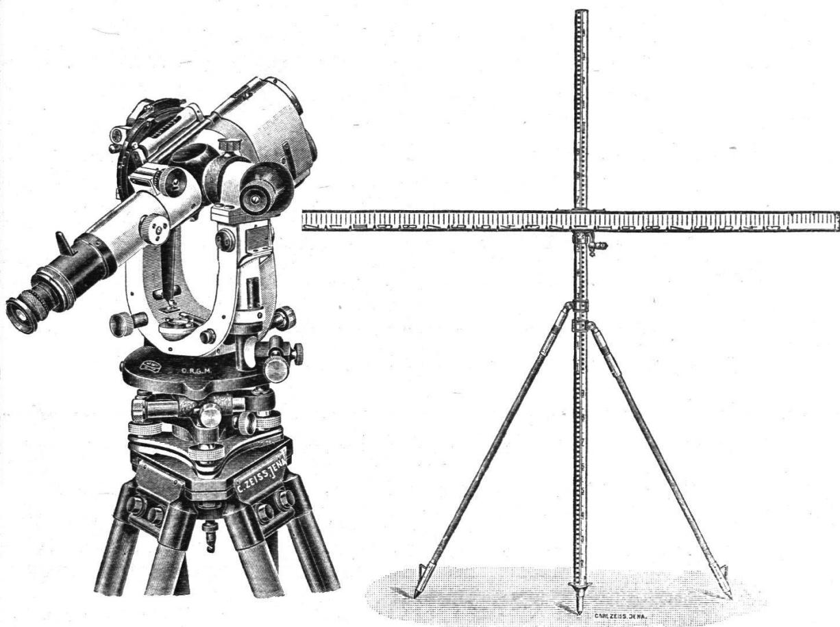
**Vollautomatisch reduzierender Präzisions-distanzmesser und Universaltheodolit**
