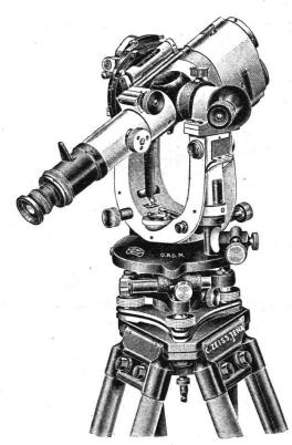
Präzisionsinstrument für Polygonisierung und Katastermessung in Ebene und Gebirge
