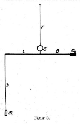
Um noch weitere Differentialquotienten des Schwerepotentiales bestimmen zu können, baute dann Eötvös die sog. 2. Art der Drehwage, deren Prinzip das folgende ist:
