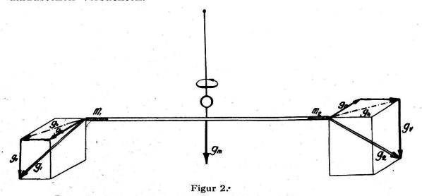
Das entstehende Drehmoment dreht nun den Balken um die Drahtachse. Dadurch wird der Draht F, der an seinem obern Ende fest mit dem Traggehäuse verbunden ist, gedrillt (tordiert). Dieser Torsion setzt der Draht einen Widerstand entgegen, der proportional zum Tor-
