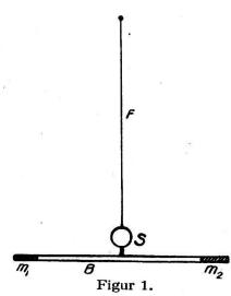
An den Enden eines dünnen Aluminiumrohres B sind die einander gleichen Massen  $m_1$  und  $m_2$  befestigt. Im Schwerpunkt des Balkens B ist normal zu seiner Längsachse ein kurzes Stäbchen s angebracht, welches einen kleinen Spiegel trägt. Das Stäbchen s ist an einem sehr feinen Drähtchen F, einem sog. Torsionsfaden, aufgehängt. Als Material für F wählt man Platiniridium, Quarz oder in neuester Zeit Wolfram-Einkristallfäden. Was wir hier beschrieben haben, stellt die Drehwage erster Art dar.
