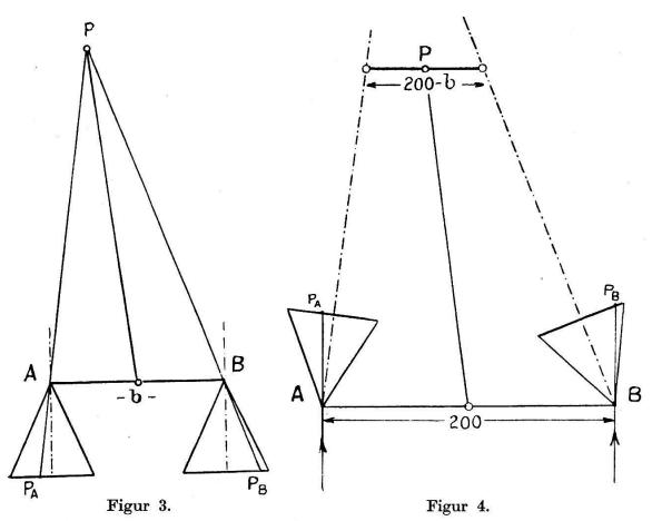
Im Autographen ist aber die Basis b nicht zwischen den Kammern einstellbar, da deren Abstand konstant 200 mm ist. Dagegen könnte nach der untenstehenden Figur 4 der Abstand der Lenkerführungen bei P von 200 mm auf 200 — b reduziert werden, wobei die Mitte dieses Stückes dem Punkt P entspräche.
