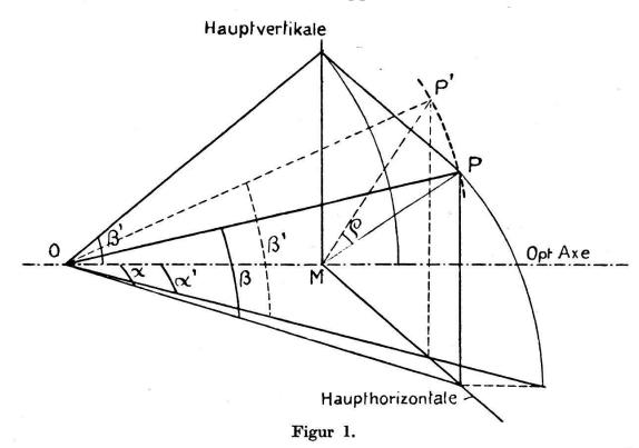
Kamera bis der Strahl OP mit der Achse OM zusammenfällt, so erhält man die Winkel a' und  $\beta'$ , vorausgesetzt, daß die Kippachse die Schwenkung mitmacht. Diese Winkel a' und  $\beta'$  definieren jedoch einen von P verschiedenen Punkt P'. Herr Wild hat gefunden, daß die beiden Punkte P und P' auf einem Kreise liegen, dessen Zentrum in M ist. Den Drehungswinkel  $\rho$ , den es braucht, um den Punkt P' an die Stelle des Punktes P zu drehen, erhält man aus der Gleichung
