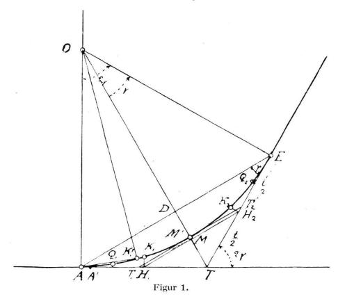
Nun ergeben sich aus der Fig. 1 sofort folgende Werte für eine Richtungsänderung  $2\gamma$ , welche gleich ist dem Zentriwinkel:
