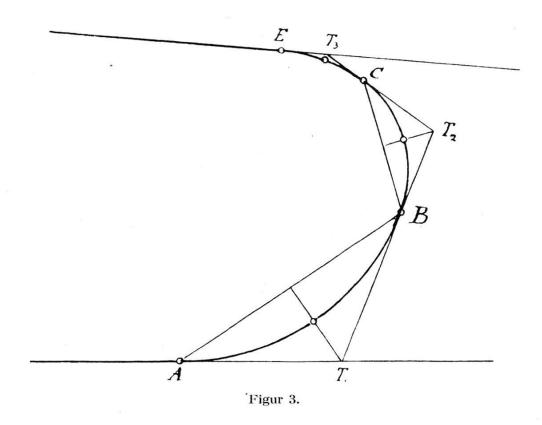
Ist außer den obigen Elementen noch ein weiterer Punkt C der Kurve gegeben, so erhält man einen dreiteiligen Korbbogen, z. B. wie Fig. 3. Man ermittelt die Tangente  $T_1$  B ganz wie oben gezeigt wurde, verbindet B mit C, errichtet in der Mitte dieser Sehne die Senkrechte bis zum Punkt  $T_2$ , bringt  $T_2$  B zum Schnitt mit der gegebenen Tangente in  $T_3$  und braucht nun nur mehr die Zwischenpunkte dieser drei Bogenteile abzustecken.
