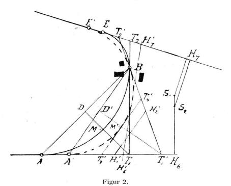
so lange bis daß die beiden Lote gleich lang sind. Deren Fußpunkte  $H_6$  und  $H_7$  liefern in ihrer Verbindungslinie eine Parallele zur Scheiteltangente der Kurve.
