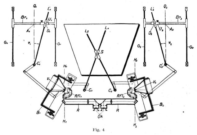
Die Mittel zur Punkteinstellung sind bei der Ausführungsform 1920 dieses Patents, dem von der Firma G. Heyde in Dresden gebauten Autokartographen<sup>4</sup> vier horizontal gelagerte, zwangsläufig verbundene Lineale L (Fig. 4), deren Ziehkanten den vier Projektionen der beiden Bildstrahlen entsprechen. Die Lineale werden durch eine ebene Kreuzschlittenführung in Drehung gesetzt, wobei sich diese Drehung zwangsläufig auf die entsprechenden Bildträger B bzw. Eintrittsspiegel RFl überträgt.
