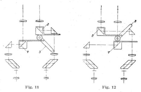
Durch den äußerst kompendiösen, auch die Zeichenvorrichtung enthaltenden Aufbau wird es jetzt möglich, nicht nur die Einstellung der Bildträger, sondern auch der Basiskomponenten vom Sitze des Beobachters aus vorzunehmen. Damit aber wird das optisch-mechanische
