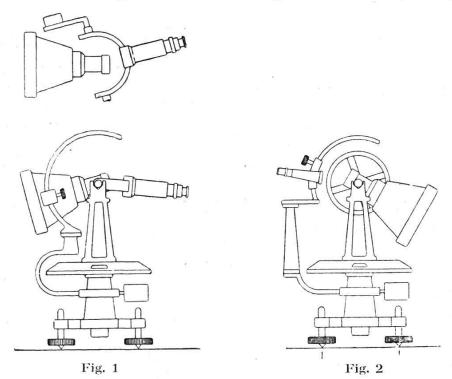
Von diesen beiden, schon von Koppe<sup>1</sup> angegebenen Möglichkeiten ist die letztere praktisch zunächst unbrauchbar insofern, als im allgemeinen die Richtung der beweglichen Kammerachse der Richtung des eingestellten Zielstrahles nicht entspricht. Diese Möglichkeit ist aber trotzdem benutzt worden bei der Konstruktion von Wild<sup>2</sup>, bei der die
