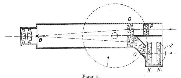
der unteren Objektivhälfte hintereinander angeordnet sind (Fig. 5). Jeder erzeugt somit je die Hälfte des parallaktischen Winkels. Figur 5 stellt einen schematischen Vertikalschnitt des neuen Tachymeterfernrohres dar. Darin ist zwischen den Keilen  $K_1$  und  $K_2$  und dem Objektiv O noch ein Rhomboederprisma Q eingezeichnet, welches das die Keile passierende Strahlenbündel in das Objektiv lenkt und der besonderen Form der Keile wegen notwendig ist.
