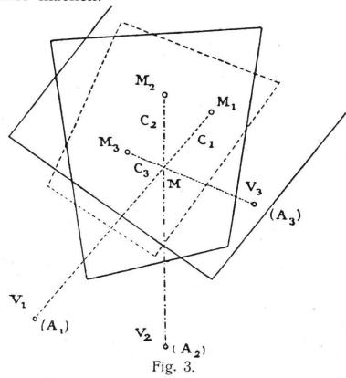
Seien  $V_1, V_2, V_3...$  (Fig. 3) die Lagen der photographischen Stationen auf der Karte,  $A_1, A_2, A_3...$  die Höhen dieser Stationen über der Ebene T und  $M_1, M_2, M_3...$  die durch die jeweilige Restitution der Platten  $P_1, P_2, P_3...$  gewonnenen Perspektiven des Geländepunktes M.
