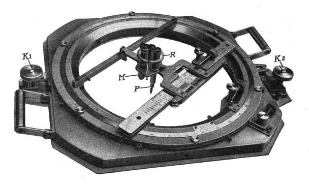
bei einem Repetitionstheodoliten lassen sich auch hier diese beiden Ringe unabhängig von einander zentrisch bewegen und durch je eine Klemme mit Mikrometerschraube genau in der gewünschten Lage feststellen. Der äußere Ring trägt eine Kreisteilung (½0 neue Teilung) von zirka 35 cm Durchmesser.
