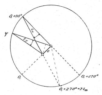
Wir wissen nun, daß bei einem Theodolit, bei dem der Einfluß der Exzentrizität auf die halbe Differenz diametraler Ablesungen im Maximum  $\varepsilon_m$  Sekunden beträgt und für eine gewisse Kreisablesung  $0_1$  null ist (siehe nebenstehende Figur), bei einer Ablesung  $\varphi$  den Wert annimmt:  $\varepsilon \varphi = \varepsilon_m \sin (\varphi - 0_1)$  (19) Es enthält also das erste
