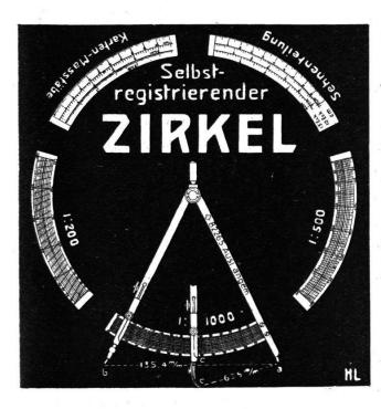
Nur ist der rechte Schenkel als fest, der linke dagegen als der Pendel- oder Schlagschenkel zu trachten. Neu dagegen ist, daß unmittelbar über den Spitzen ein zur Axe des Zirkels konzentrischer Bogen angebracht ist, der mit dem rechten Schenkel fest verbunden ist, während er durch eine Durchbrechung des linken Schenkels durchgeht, so daß dessen Bewegung unbehindert bleibt. Auf diesem Bogen
