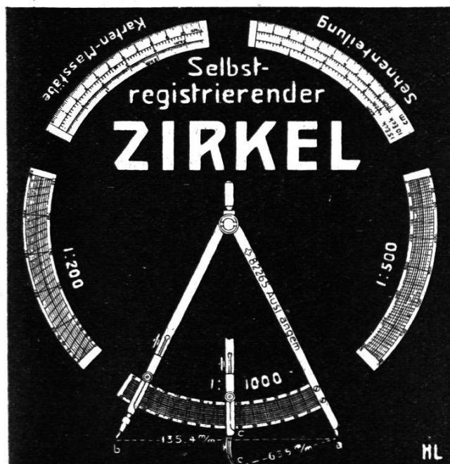
Nur ist der rechte Schenkel als fest, der linke dagegen als der Pendel- oder Schlagschenkel zu betrachten. Neu dagegen ist, daß unmittelbar über den Spitzen ein zur Axe des Zirkels konzentrischer Bogen angebracht ist, der mit dem rechten Schenkel fest verbunden ist, während er durch eine Durchbrechung des linken Schenkels durchgeht, so daß dessen Bewegung unbehindert bleibt. Auf diesem Bogen
