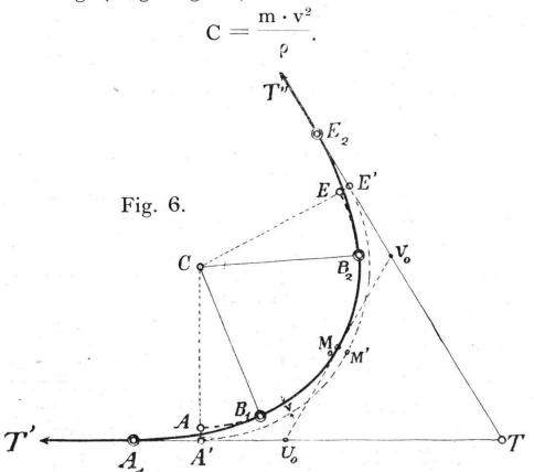
Diese, ebenfalls in S angreifende, stets in radialer Richtung horizontal nach aussen gerichtete Kraft C ergibt mit G die Resultierende
