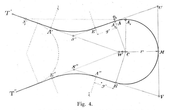
1. In der Halbierungslinie des Winkels T'WT" wird ein Punkt C als Mittelpunkt eines Kreisbogens  $\widehat{AE}$  mit dem Minimalradius r=20 m—e so gewählt, dass C um die Strecke W C = e ausserhalb jenes Winkels liegt; kommt ein Verkehr
