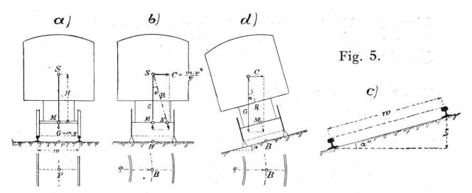
gleichmässig auf die beiden Räder und die beiden Schienen erfahren durch diese einen gleich grossen Druck, der in der vertikalen Symmetrieachse der Schienen wirkt, sofern man deren kleinen Anzug ausser Betracht lässt.
