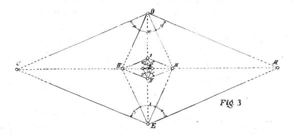
Die Punkte A, III, IV, C sind gleichzeitig mit Signalstativen zu besetzen. Die Punkte D, I, II, E sind Theodolitstände. Bei Bearbeitung mit zwei Theodoliten kommt der eine auf D und I, der andere auf E und II in Verwendung.
