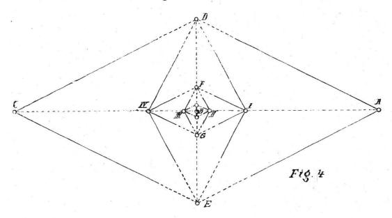
In den Punkten D, F, G, E stehen die vier Signalstative, während A, I, II, III, IV, C Theodolitstände sind. Bei zwei Theodoliten soll der eine die Stationen A, I, II, der andere III, IV, C absolvieren.
