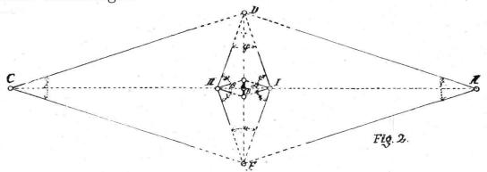
Die Figur soll analog abgesteckt sein, wie die Raute mit 2 Faktoren; auch hier sollen die Winkel  $\alpha, \beta, \gamma, \delta, \varphi, \mu$  auf eine halbe bis höchstens eine ganze Minute genau gleich gross abgesteckt werden.
