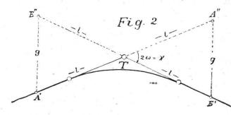
Nach Figur 2 können diese Winkel aber auch ohne Theodolit durch blosse Längenmessungen auf der einen und auf der Verlängerung der andern Endtangente bestimmt
