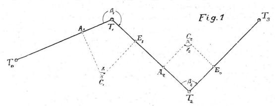
den Vierecken ATEC beträgt die Summe der beiden Winkel bei T und C stets zwei rechte Winkel; als «Tangentenwinkel» beim Punkte  $T_i$  bezeichnen wir aber nicht den Winkel  $T_i = 2 \cdot R - C_i$ , sondern den Polygonwinkel  $\beta_i = T_{i-1} \cdot T_i \cdot T_{i+1}$ , der bei der Drehung des Anfangsschenkels  $T_i \cdot T_{i-1}$  im Sinne des Uhrzeigers bis zur Richtung  $T_i \cdot T_{i+1}$  durchlaufen wird. In der Figur 1 ist daher:
