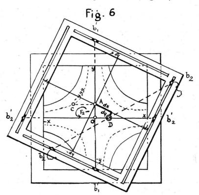
déplace-Le ment du transparent devant se faire le long d'une droite, il est possible de la marquer également au moyen d'un fil tendu entre les bornes b, b,, fil que l'on enlève, lorsque le déplacement est terminé, afin de prévenir des erreurs.
