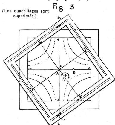
Les deux droites données par les équations ci-dessus se coupent au point D (dx, dy). Ces relations sont identiques aux équations normales donnant accroissements dx et dy à ajouter aux coordonnées provisoires x et y d'un point, de façon que l'on ait: Somme des vv = Min. Le facteur 2 de F est éliminé par une graduation appropriée des hyperboles.
