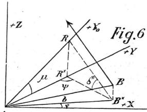
Bezeichnen wir den Neigungswinkel der optischen Achse links mit der Horizontalebene mit  $\delta'$ , so schließt diese optische Achse mit der  $X_0$   $Y_0$  Ebene den Neigungswinkel  $v' = \delta' - \mu$  ein.
