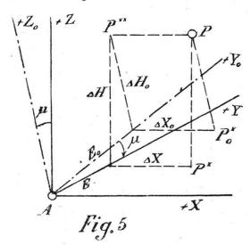
der Abstandsformeln für diesen allgemeinen Fall denken wir uns die aufzunehmenden Punkte bezogen auf ein Hülfskoordinatensystem. Dieses geht aus dem ursprünglichen System hervor durch Drehung um die x-Achse desselben um den Winkel  $\mu$ . Ein Punkt P, der in diesem neuen System die Koordinaten  $E_0$ ,  $\Delta X_0$ ,  $\Delta H_0$  besitzt, hat im ursprünglichen System:
