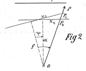
b) Ein Punkt P bilde sich auf einer vertikal gestellten Platte im Punkte  $P_3$  ( $x_3/y_3$ ) ab; wir denken uns die optische Achse in der Horizontalebene um den Winkel  $\psi$  gedreht, wobei  $\psi$  als positiv angenommen wird, wenn die
