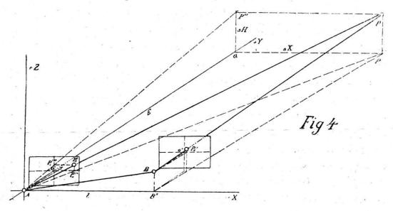
der optischen Achse. Im vorliegenden Normalfall fällt die + Y Achse mit der optischen Achse zusammen und die + X Achse mit der Horizontalprojektion der Verbindungsgeraden der Standpunkte. Aus nachstehender Figur ergeben sich für die Raumkoordinaten E, AX, AH eines beliebigen Objektpunktes folgende Beziehungen:
