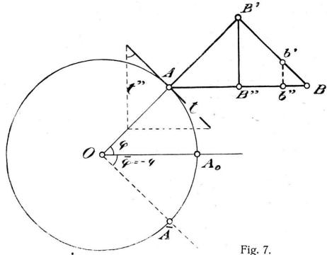
die Radien mit den Neigungswinkeln  $\varphi$  und  $-\varphi$  gegen  $A_o$  O. Nun betrachten wir zunächst A als Schwerpunkt einer Fläche F in der Tangentialebene von A; F" sei die Projektion von F auf die Normalebene zur Windrichtung A, O. Der für diese Fläche F in Betracht kommende Winddruck P ist dann:
