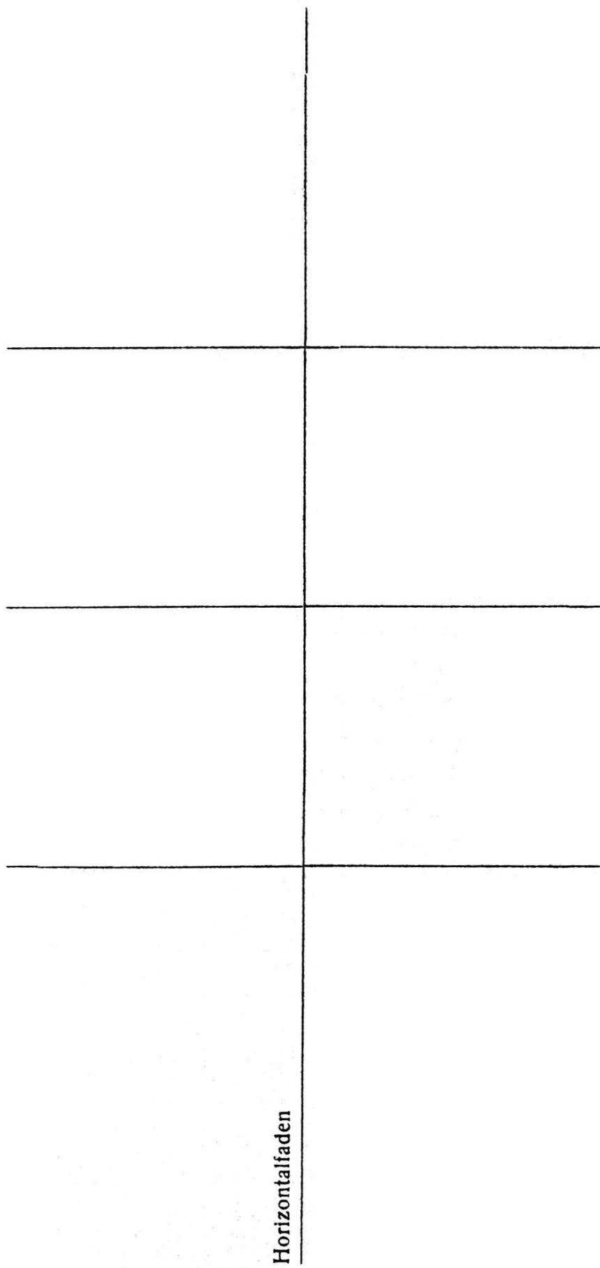
Fadenkreuz mit vertikalen Distanzfäden
