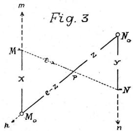
Fig. 3. Grundprinzip für die nomographische Behandlung der u-Funktion.
