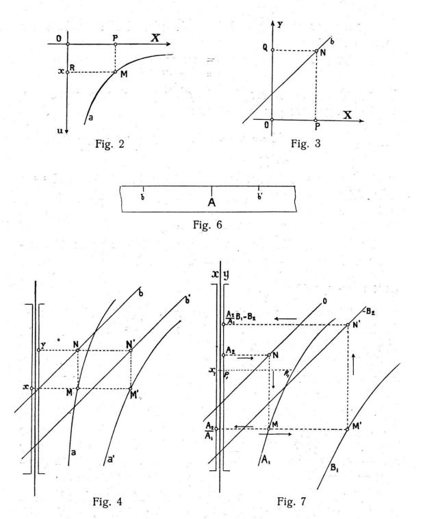
famille d'hyperboles ayant mêmes asymptotes; c'est ce qui est réalisé par l'abaque (figure 5, voir annexe). Pour la construction de ce nomogramme les paramètres a et b ont été multipliés respectivement par des constantes appropriées.
