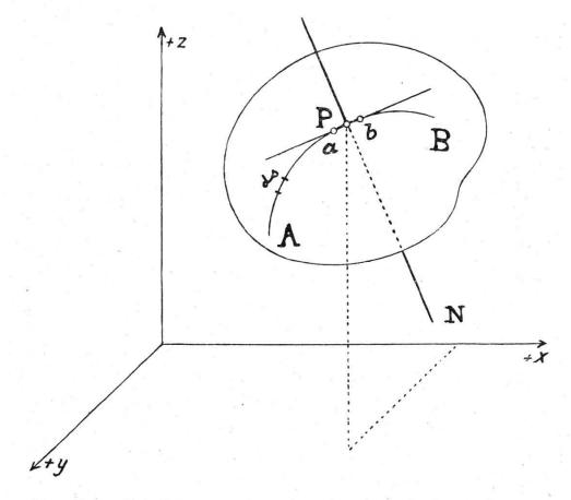
Par le point P passe un plan tangent à la surface en ce point et une droite N perpendiculaire à ce plan et qu'on appelle la normale à la surface; enfin les 3 points a P b déterminent un plan appelé plan osculateur de la ligne géodésique en P.
