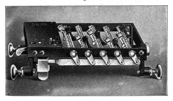
Konstantenapparat, 5stellig, zum Aufsetzen auf eine 6stellige Maschine.
