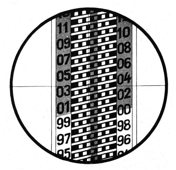
Zur Abgrenzung der ganzen Meter auf der Latte und zur Bezeichnung der Mitte der Querteilung sind die in der Figur mit schwachem Tone versehenen Flächen in Wirklichkeit mit einer leichten, gelben Farbe bemalt. Da die gelbe Farbe von der weissen sehr wenig abweicht, so wirkt diese Bemalung beim Zielen durchaus nicht störend, wie dies leider im Cliché der Fall ist.
