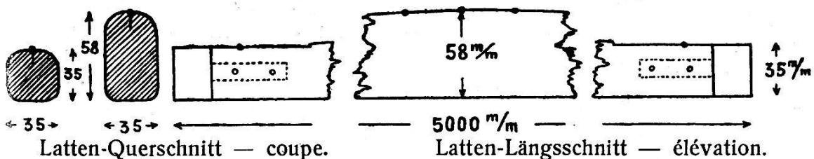
Les lattes sont munies de sabots en acier plat et d'un contrefort latéral de 0,5 m de longueur. La surface inférieure de la latte est absolument plane, le renforcement au milieu n'existe que sur la surface supérieure. La circonference de la latte est à son extrémité de 11 cm, à son milieu de 16 cm.
