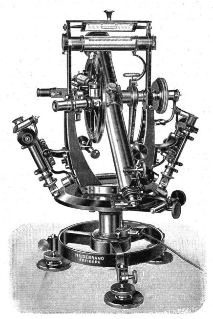
Fig. 3. Schraubenmikroskop-Theodolit mit elektrischer Beleuchtung. Signale sind die gleichen; die Winkelmessung wird in beiden Lagen des Fernrohrs und mit den Anfangsstellungen der Alhidade 0°, 45°, 90°, 135°, also in vier Doppelmessungen, durchgeführt.
