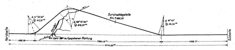
Fig. 2. Längenprofil und Situation des Lötschbergtunnels. Länge 1:100,000. Höhen 1:5000.
