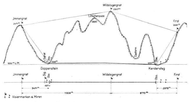
Längenprofil und Grundriss der Lötschbergtunnelabsteckung.
