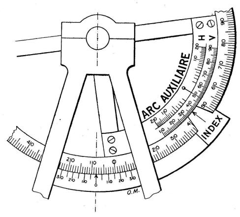
La disposition spéciale de l'arc auxiliaire est destinée à simplifier le calcul des différences de hauteurs en ne faisant intervenir dans le calcul que des angles verticaux pour lesquels la différence d'élévation correspond à des multiples simples de l'intervalle de la mire; c'est à dire des angles pour lesquels la fonction:  $\frac{1}{2}\sin 2\alpha$  est un simple multiple. Ces angles particuliers pour les multiples 1 à 20 sont donnés dans la table suivante:
