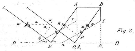
gelagerte Amslersche Rolle den Weg  $RR_1$  zurück, der sich in die Komponenten RP und  $PR_1$  zerlegt, von denen die erstere einer Abwicklung, die zweite einem Gleiten der Rolle entspricht.
