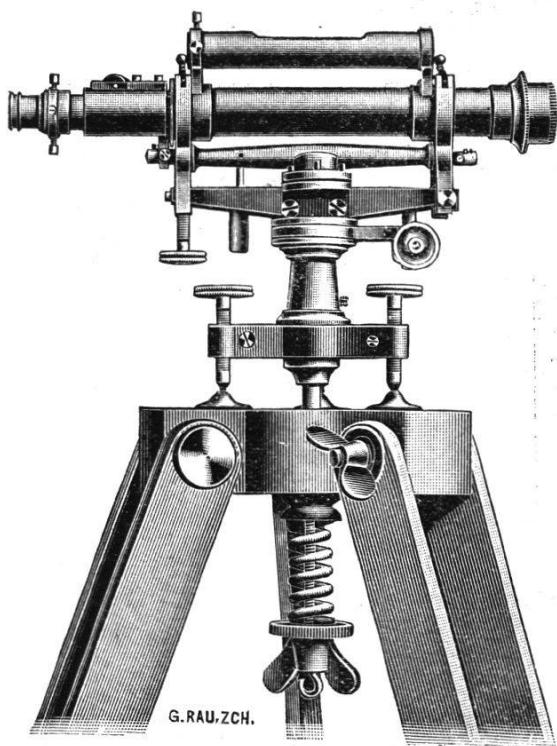
schraube, Objektivöffnung 36 mm. Ein zweites analog dem großen, jedoch kleiner, mit einer Objektivöffnung von 25 mm. Diese beiden Instrumente sind aus vorliegender Abbildung ersichtlich. Ein drittes Instrument mit umlegbarem Fernrohr, fester Libelle, ohne Elevationsschraube. Ein vierthes einfaches Instrument mit Horizontalmikrometer. Alle Instrumente sind mit Hensoldt-Optik versehen, aufs sorgfältigste bearbeitet, blau-schwarz oxidiert, einem Überzug, der äußerst solid auf dem Metall haftet.
