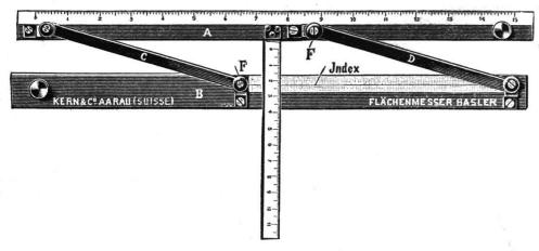
Dieser Apparat, erfunden von Herrn P. Basler, Kantonsgeometer in Aarau, und hergestellt von der Firma Kern & Co., eignet sich zur Berechnung von geradlinigen, schmalen Figuren besser als jeder Planimeter und ist dabei kein Umfahren, kein Zirkel und kein Maßstab notwendig. Am besten findet das Instrument Verwendung bei dem bei ländlichen Katastervermessungen gebräuchlichsten Maßstab 1:1000, kann aber für jeden andern Maßstab verwendet werden ohne Abänderung der Einteilung.
