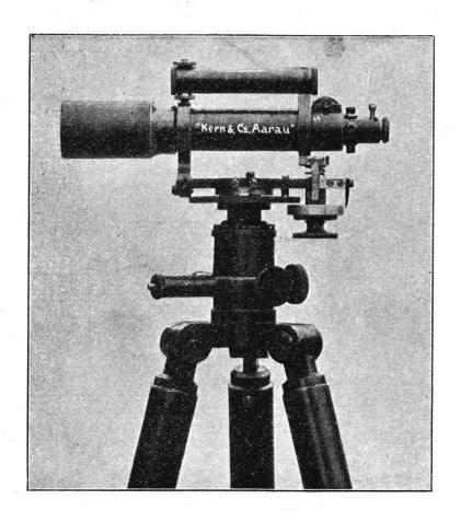
Dieses Instrument mit seinem metallenen Stativ wiegt nur 2<sup>1</sup>/<sub>2</sub> Kilo, eignet sich folglich sehr gut für Reisen. In der Hauptsache kommt solches zur Verwendung bei technischen Vorarbeiten von Wegen, Straßen, Eisenbahnen, Kanälen, Drainagen etc., so-
