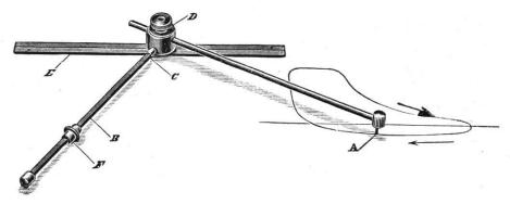
Große Einfachheit des Mechanismus, keine Gelenke mit Spitzen und Zapfen, kein toter Gang, geringste Abnützung und deshalb dauerhaft. Größe des rollenden Rädchens ohne Einfluß auf die Wirkungsweise des Instrumentes, die Schneide kann deshalb bei eventueller Abnützung nachgeschärft werden. Natur der Meßfläche absolut ohne Einfluß, die gezahnte Schneide läuft über alle Un-
