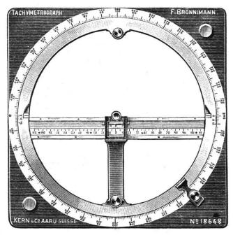
steg montierte Nonius mit Abstechapparat gestattet genaues Arbeiten.
