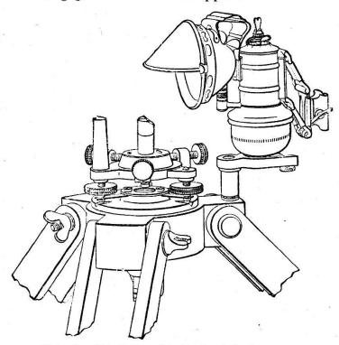
Abb. 4. Stativkopf mit Acetylenlampe.
