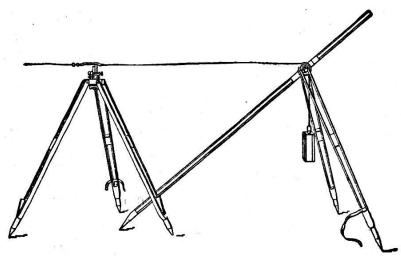
Abb. 2. Markenstativ und Drahtstütze.
