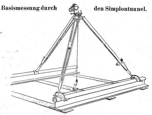
Abb. 3. Aufstellung des Markenstativs auf den Schienen.
