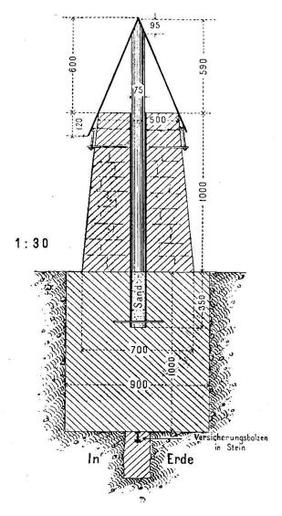
auftreten, eine der ersten Bedingungen für jede gute Triangulation. Es ist wohl kaum nötig beizufügen, daß jede trigonometrische Station noch sekundär — durch in die Felsen eingehauene Kreuze etc. — versichert ist.
