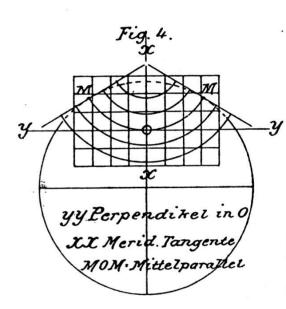
Bei der winkeltreuen normalen Kegelprojektion denkt man sich einen Kegelmantel norauf den Parallelkreis Landesmittelpunktes aufgesteckt, so daß die Kegelspitze sich in der verlängerten Erdachse befindet. dessen Infolge werden Punkte des Mittelparalleles mit dem Berührungskreis des Kegels zusammenfallen. Um nun Bild der gewölbten Erdoberfläche dem abwickelbaren Kegelmantel zu projizieren, denkt man
