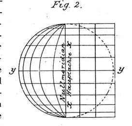
Gegensatz zu der vorgenannten als transversale Zylinderprojektion gekennzeichnet und ist unter dem Namen konforme Gaußsche Projektion bekannt. Das mit dem vorigen identische Vergrößerungsverhältnis in dem auf den Meridian als Hauptachse bezogenen Koordinatensystem lautet
