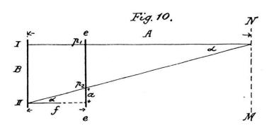
In dieser Figur sei B die Basis, von deren Endpunkten I und II photographiert wurde, f die Brennweite des benützten Objektivs, und denkt man sich die beiden Bilder, analog ihrer Lage im Comparator, derart aufgestellt, daß das Bild  $p_1$  des zu bestimmenden Punktes P in einer auf B senkrecht stehenden Horizontalen liegt und ist  $p_2$  der idente Punkt im rechten Bild, so ist a die im Comparator gemessene Parallaxe.
