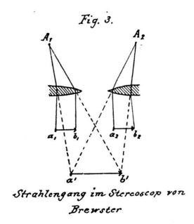
Es werden die Hälfte einer Sammellinse, wie Fig. 3 zeigt, in eine Fassung gebracht. Auf der den Augen entgegengesetzten Seite werden 2 ähnliche Bilder angebracht, welche durch den Strahlengang zu einem plastischen vereinigt werden. Bemerkenswert dabei ist, daß man beim seitlichen Verschieben nur eines Bildes, im Bewußtsein nicht eine seitliche Verschiebung, sondern ein Vor- resp. Nachrücken der ganzen
