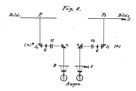
Einrichtung w. Strahlengang d. Stereocomparators
