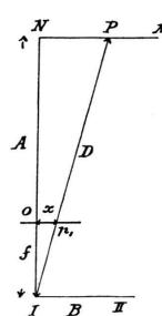
Es sei in Fig. 12 *B* die Basis, *e* das linke Bild in richtiger Orientierung, also o der Hauptpunkt und *x* die dem Bildpunkte *p* zugehörige Abscisse, so liegt der wahre Landschaftspunkt *P* im Schnitte des Strahles *Ip* mit der Geraden *M N*. Somit verhält sich
