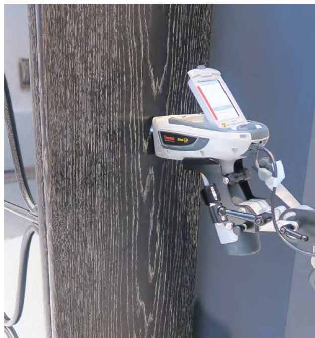
13 Analyse de la céruse de la bibliothèque vitrée avec le spectromètre de fluorescence X. MAH, inv. AD 3731.
