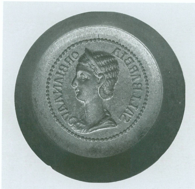
7 (à gauche). Coin pour frapper l'avvers de la figure 4 | Acier, 152,8 g, Ø surface 33 mm (MAH, inv. CdN 2007-43)
