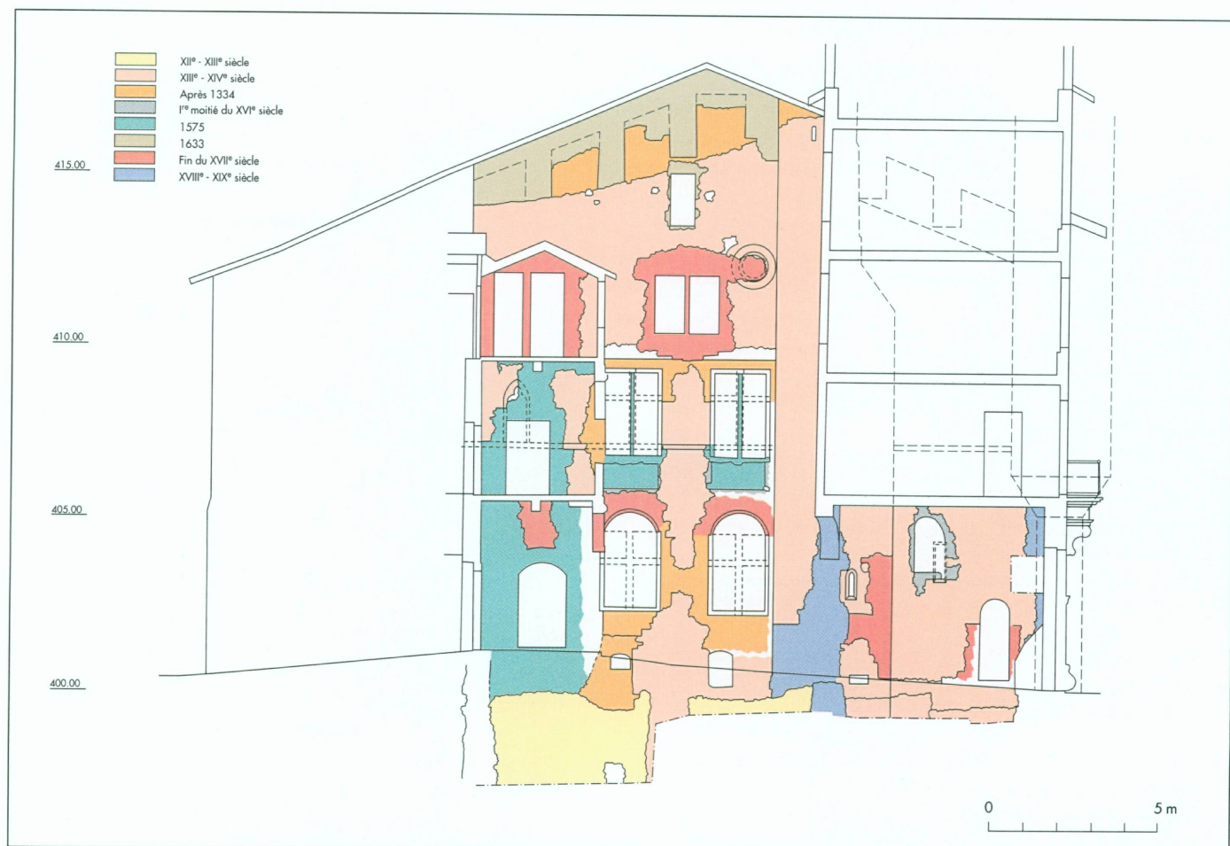
44. Maison Tavel | Analyse schématique de la face extérieure du mur pignon sud (éch. 1/200)
