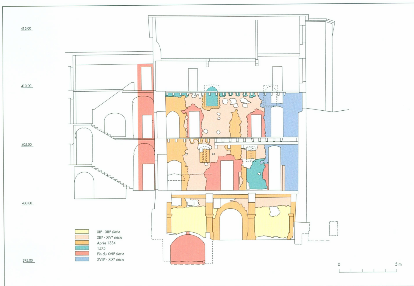
41. Maison Tavel | Analyse schématique de la face interne de l'ancienne façade ouest (éch. 1/200)
