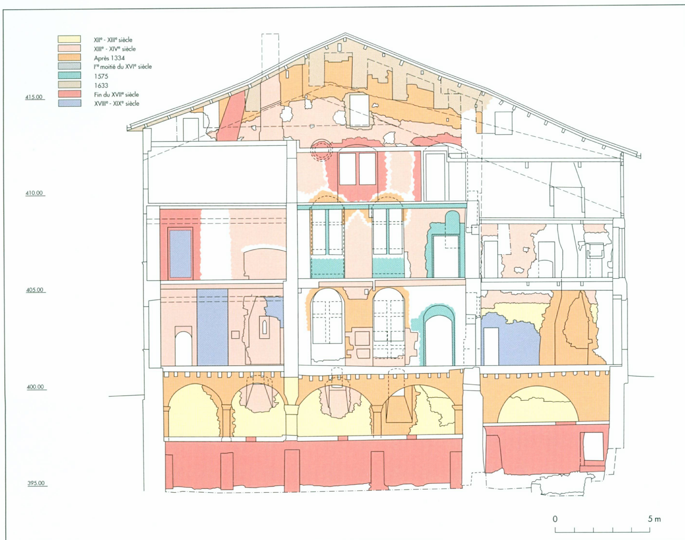
45. Maison Tavel | Analyse schématique de la face interne du mur pignon sud (éch. 1/200)
