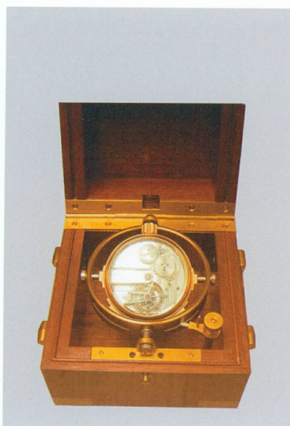
136. James Pellaton (1873-1954), horloger Chronomètre à tourbillon dans son coffre , Le Locle (Suisse), vers 1900
