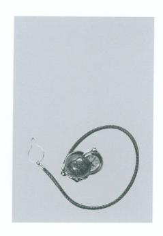
159. Guisto (maison active au XX° siècle) *Montre de poche*, Suisse, vers 1930 Boîte ronde en nickel chromé; cadran en métal argenté; aiguilles en acier bleui, forme dite «Breguet» Échappement à cylindre; calibre à ponts Cadran signé *Guisto/SWISS MADE* Ø 4,0 × ép. 1,0 cm Acquis de M. Olivier Comte, Genève (Suisse), en 1992 Inv. AD 8115
