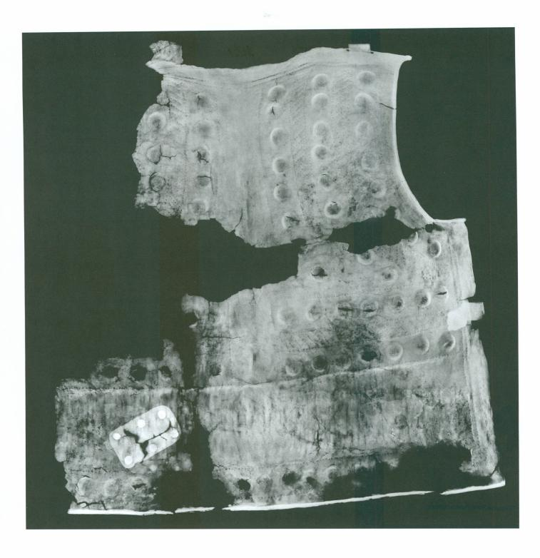
5. Assemblage des radiographies prises à haut kilovoltage mettant en évidence l'état de la tôle métallique: on peut y observer l'emplacement des lacunes, les fissures, le degré de minéralisation et les traces de martelage | Radiographies. 95 kV, 3,5 mA, 2"; assemblage au scanner et restitution Team Color
