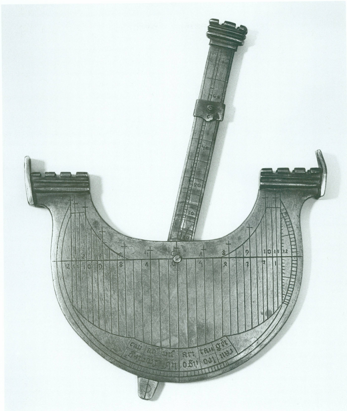
6. Navicula de Venetiis , non signée ni datée, mais portant des inscriptions en caractères gothiques qui situent sa fabrication au XIV e ou XV e siècle. La face principale représente un cadran solaire rectiligne universel, adapté à une forme de bateau qui évoque les anciens vaisseaux vénitiens. H. 15,5 cm. Genève, Musée d'histoire des sciences, Inv. 2139.
