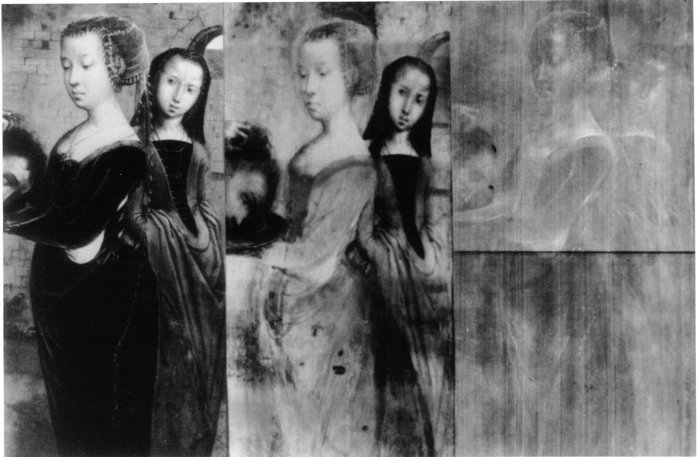
10 a.b.c. La Décollation , Juan de Flandes, détail du personnage de Salomé en lumière normale, IR (tube vidicon Hamamatsu n° 2606-06, logiciel de traitement et assemblage d'images infrarouges Mosart, Amparo Corporation, Santa Fe, USA), et radiographie (48 kV, 2 min, 2,5 mA, films Structurix D4, Agfa-Gevaert, 30 x 40 cm).
