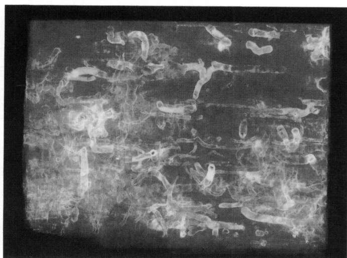
10. Radiographie de conifère vermoulu imprégné d'huile de lin et blanc de plomb.
