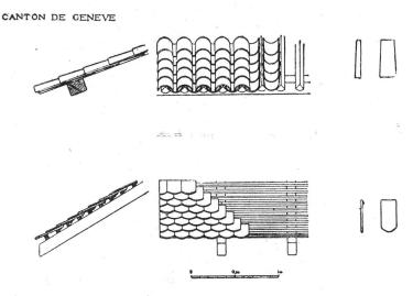
Fig. 5. — Tuiles creuses et tuites plates.
