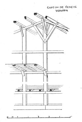
Fig. 7. - Vernier C. Détail de la «couble».
