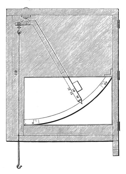
d'aiguille pour le cadran, et son extrémité porte de même une aiguille en forme de fourchette, dont les deux pointes indiquent, sur les deux cadrans, la charge placée dans la seille. Cette balance doit être aussi enfermée dans 17 nov. une cage avec portes vitrées, et le montage doit également être fait de manière à ne pouvoir être changé sans ouvrir la cage.
