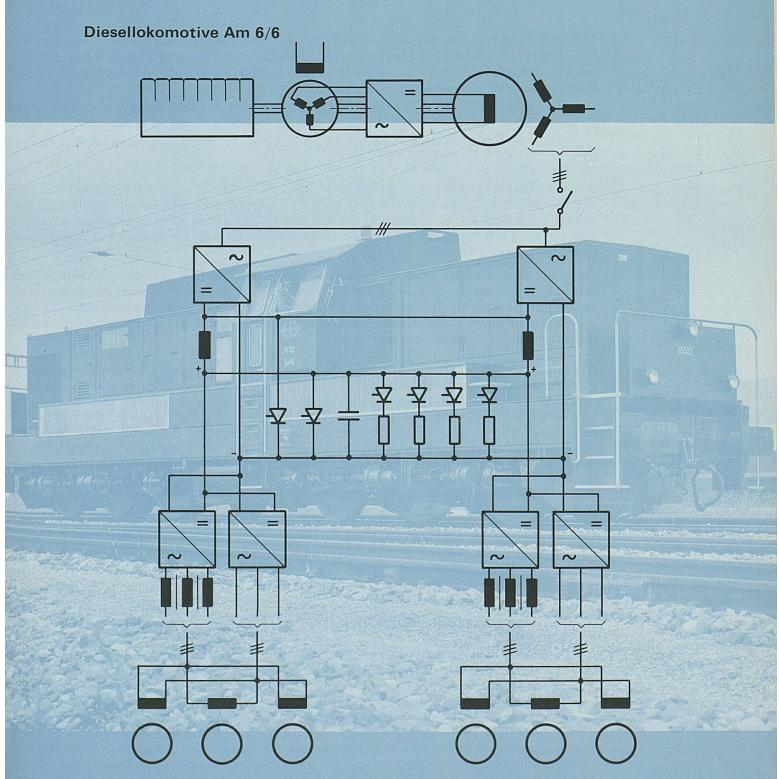
Die Diesellokomotive Am 6/6 wird im schweren Rangierdienst und bei Hilfeleistungen eingesetzt. Die Anwendung der Umrichtertechnik auf Halbleiterbasis und der Einbau von Drehstrom-Asynchron-Fahrmotoren führen zu einer bedeutenden Senkung des Unterhaltsaufwands. Die kleinere Masse der Asynchron-Fahrmotoren vermindert zudem die Kräfte zwischen Rad und Schiene bei Kurvenfahrt.
