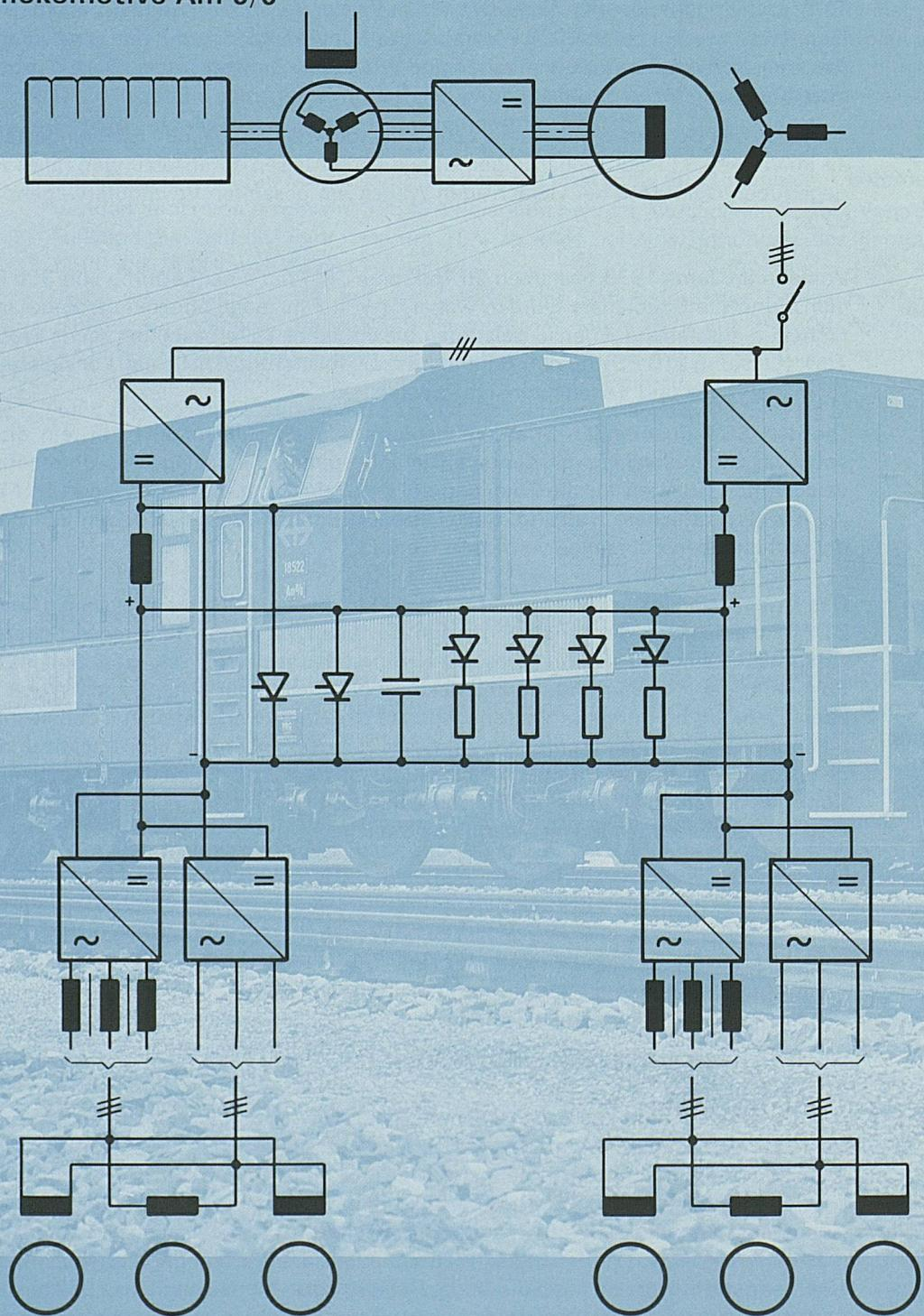
Die Diesellokomotive Am 6/6 wird im schweren Rangierdienst und bei Hilfeleistungen eingesetzt. Die Anwendung der Umrichtertechnik auf Halbleiterbasis und der Einbau von Drehstrom-Asynchron-Fahrmotoren führen zu einer bedeutenden Senkung des Unterhaltsaufwands. Die kleinere Masse der Asynchron-Fahrmotoren vermindert zudem die Kräfte zwischen Rad und Schiene bei Kurvenfahrt.
